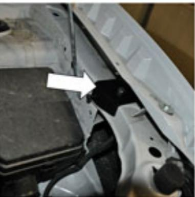
2. Установить кронштейн крыла в отверстие, как показано на рисунке. Плотно прижать подгиб кронштейна к кузову и затянуть болт M8x20 и гайку M8 с шайбой 8 торцевой головкой №13 с усилием 23 Нм.
